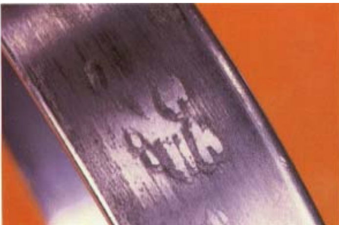
Corrosión por frotación en las superficies de calibre O.D
