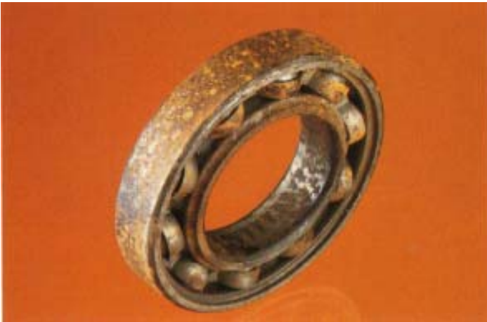
Corrosión atmosférica (oxido)
