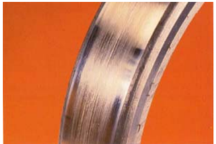
Escurrimiento plástico- superficie de calibre O.D suave y pulida y superficie de nervadura en donde este collar de bolas ha estado girando excesivamente en la carcasa.
