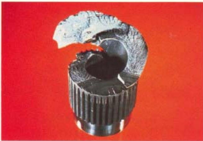
Este eje de rueda frontal falla a causa de fatiga por flexión
