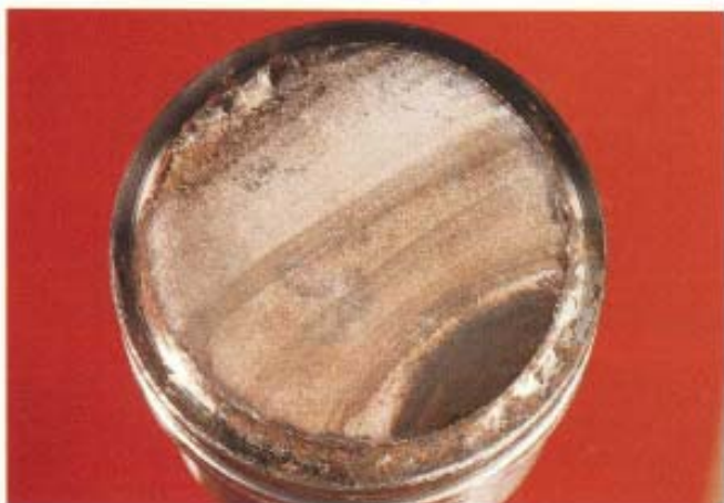
Este eje se fracturo por fatiga en un filete. Las marcas de playa se extienden por una gran porción de la superficie de fractura, indicando una carga relativamente liviana. Hay corrosión en el sitio de inicio. (Inferior derecho)
