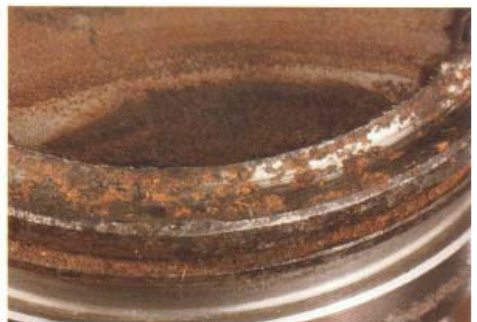
Esta vista ampliada del punto de iniciación revela oxidación. Esto es posiblemente un tipo especial de fractura llamada fatiga por corrosión causada por un medio ambiente corrosivo.
