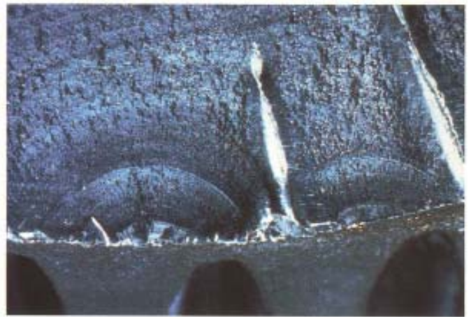
La ampliación de los puntos de inicio revela la ausencia de concentradores de tensión anormales. Este eje fue sobrecargado cíclicamente durante la operación.
