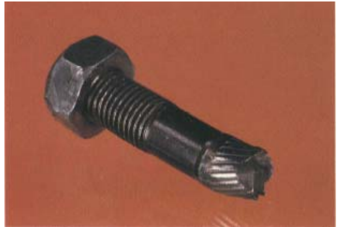
Ahora observamos una falla por sobrecarga de ciclo simple. Las señales son la deformación plástica, las superficies de fracturas oscuras, ásperas y rugosas con labios de corte.
