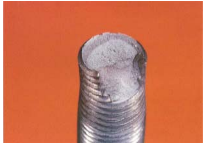
Ahora observamos una falla por sobrecarga de ciclo simple. Las señales son la deformación plástica, las superficies de fracturas oscuras, ásperas y rugosas con labios de corte.
