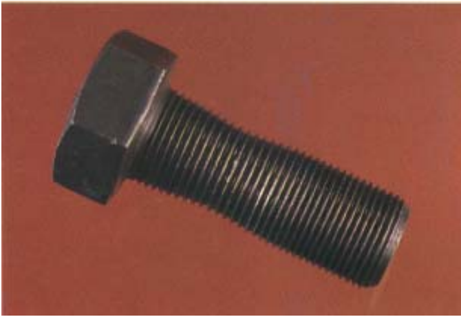
Aquí vemos un bulon sobrecargado y con deformación plástica (estirado).
