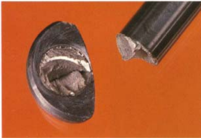
Aquí observamos un tratamiento térmico inadecuado (enfriamiento demasiado rápido o de la forma incorrecta) que provocó una fractura por templeado en el filete por debajo de la cabeza de este bulón.
