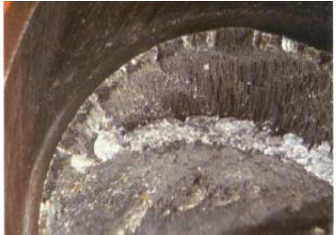
Este acercamiento revela una banda más angosta más oscura y cristalina alrededor de la circunferencia de la superficie de fractura. Esta banda es la fractura por templeado que produjo un concentrador de tensión provocando una fractura dúctil bajo el efecto de la carga.
