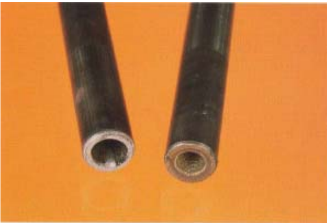
El desgaste excesivo de la guía de la válvula de escape se puede producir en un ambiente corrosivo,
