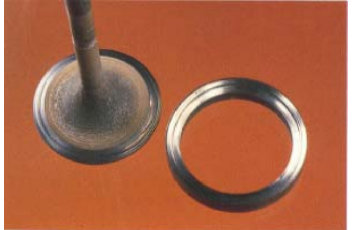
El ranurado profundo puede ser el resultado de corrosión, pero también puede ser la consecuencia de partes incorrectas (asientos de válvulas diesel usadas en un motor a gasoil, etc.)
