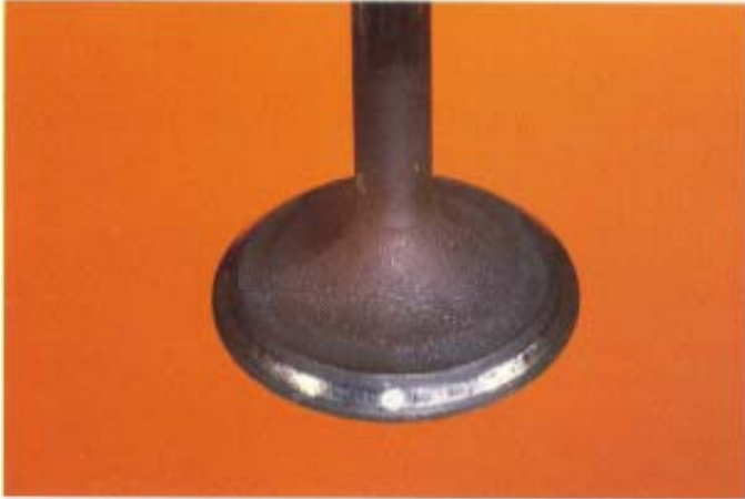
La picadura del asiento de la válvula puede producirse por un ataque corrosivo.
