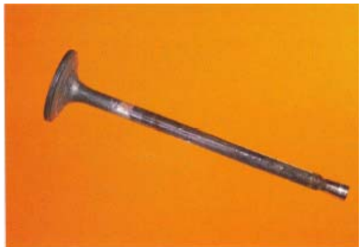
La oxidación de los vástagos de las válvulas revela la presencia de calor y corrosión
