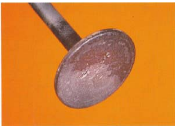
La oxidación y desescamado de las cabezas de las válvulas indica un sobrecalentamiento.
