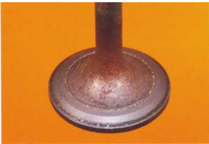
Las fracturas por fatiga termal se encuentran con frecuencia en válvulas de dos piezas que han estado demasiado calientes.
