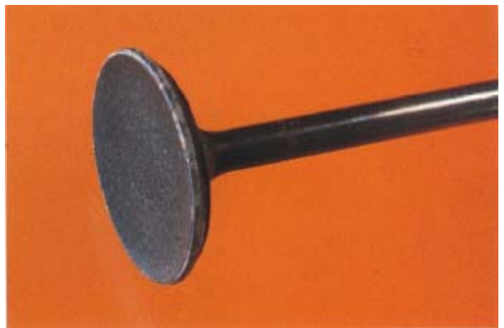
El acopado por lo general se percibe en las válvulas de una pieza que han sido sobrecalentadas.
