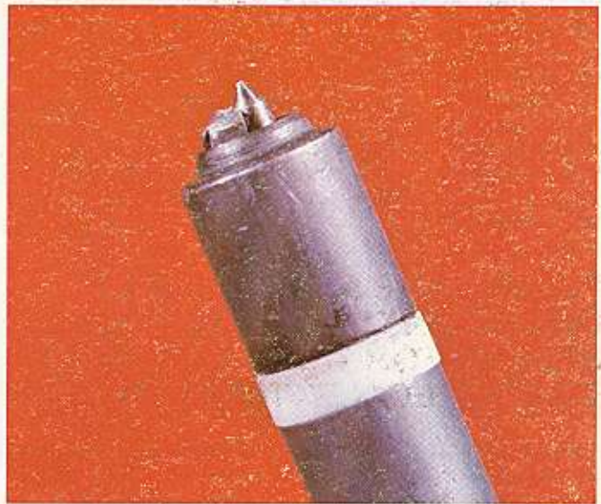
Ilustración 56 — Punta de boquilla quebrada debido a un impacto fuerte.
