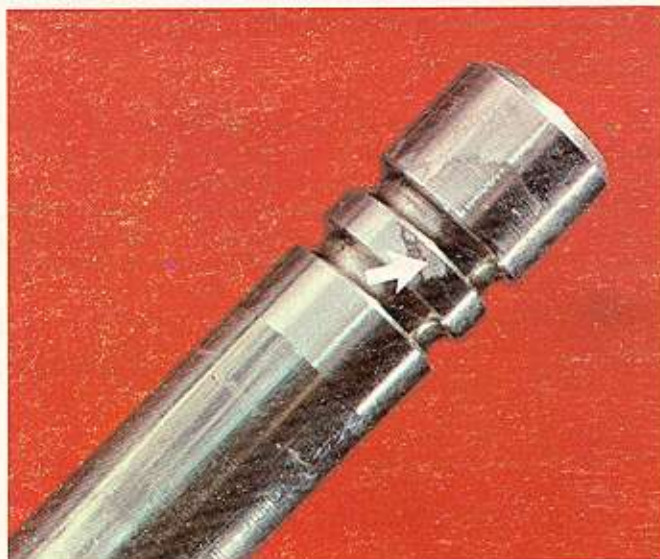
Ilustración 6 — Válvula con ludimiento excesivo cerca de la ranura del retén.
