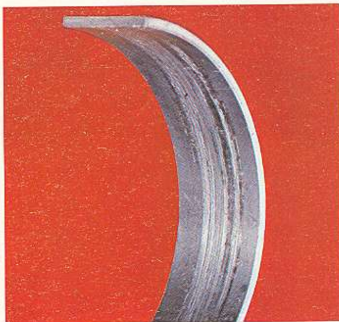
Ilustración 22 — Cojinete dañado por materias extrañas.
