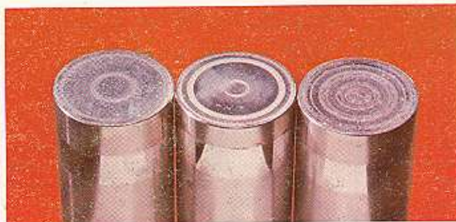
Ilustración 10 — Los levantaválvulas de la izquierda y del centro tienen desgaste normal. El levantaválvulas de la derecha tiene un desgaste excesivo.
