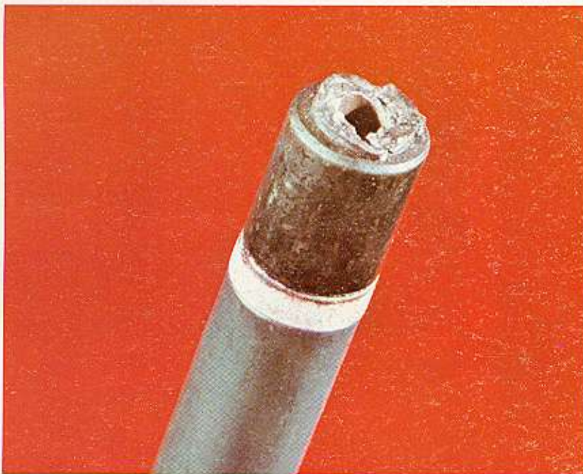
Ilustración 55 — Punta de boquilla dañada por materias extrañas.
