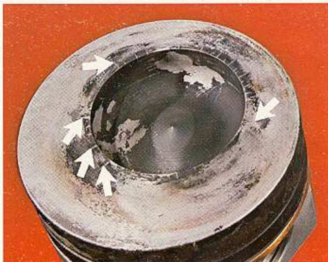
Ilustración 37 — Pistón con grietas en el cráter. Las flechas muestran el ancho de las grietas.
