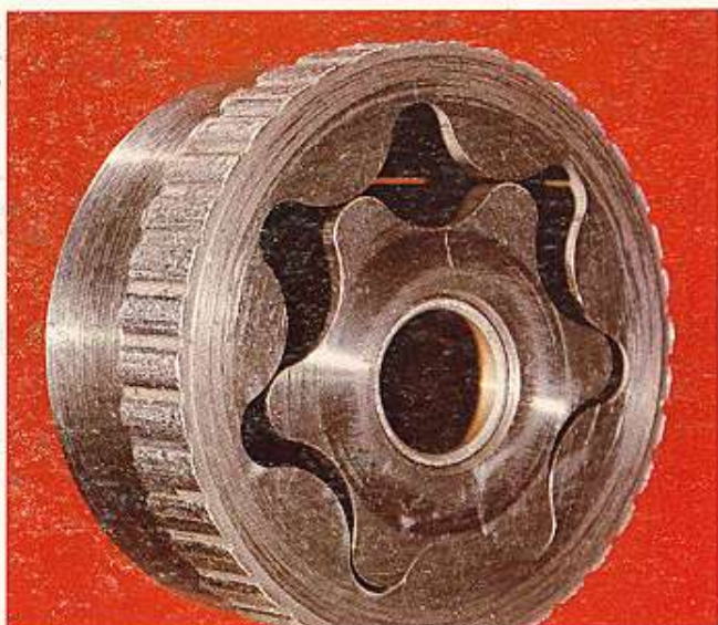
Ilustración 66 — Bomba del aceite con dientes de engranaje quebrados o desgastados.
