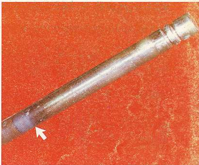
Ilustración 4 — Descoloración azul excesiva en vástago de válvula.
