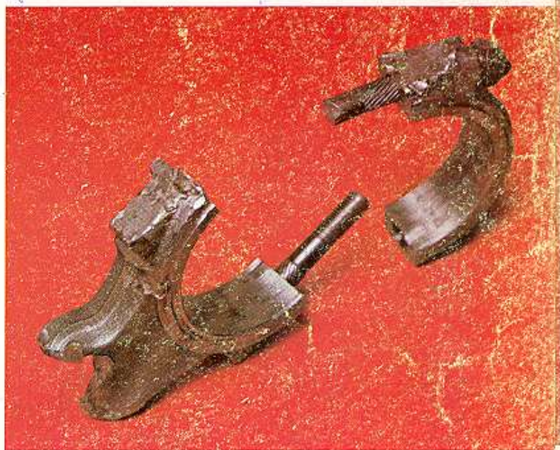
Ilustración 45 — El daño de la biela empezó con un perno quebrado.
