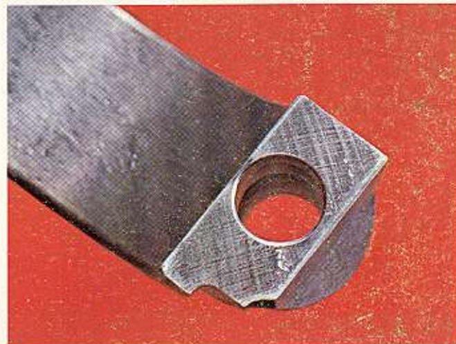
Ilustración 40 — Perforaciones en la superficie de contacto de la tapa producidas por materias extrañas.
