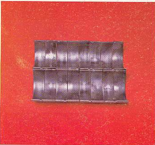
Ilustración 21 — Cojinetes de biela obscurecidos en la superficie completa de fricción, producido por combustible en el aceite.
