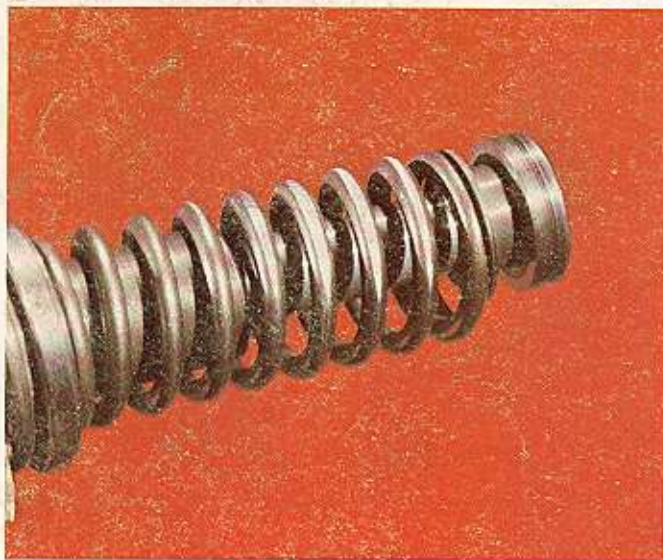
Ilustración 62 — Resorte de émbolo con desgaste en el lado, y que puede volver a usarse nuevamente.
