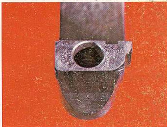
Ilustración 41 — Ludimiento en la tapa de la biela.
