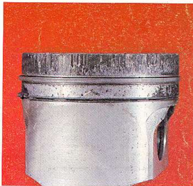
Ilustración 24 — Juego excesivo entre el lado del anillo y su ranura. Obsérvese que la abertura es grande entre la parte superior del anillo y la ranura.
