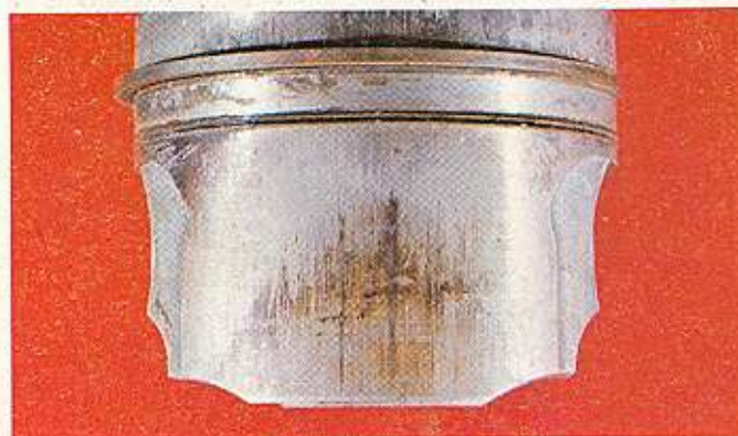
Ilustración 30 — Cuerpo de pistón rayado debido a arranque frío.
