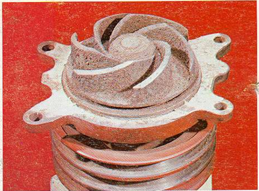
Ilustración 69 — Depósitos de herrumbre en el rodete de bomba del agua.
