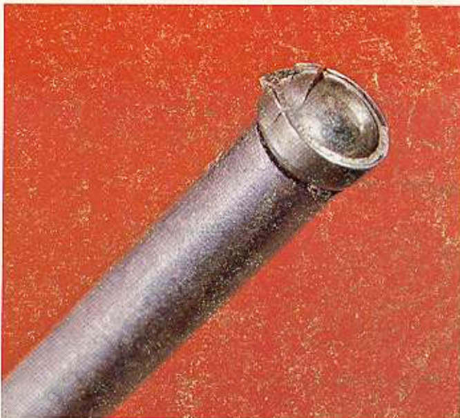
Ilustración 9 — Copa de la varilla de empuje dañada.
