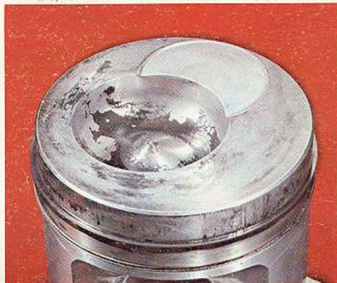
Ilustración 7 — Pistón dañado debido a que golpeaba una válvula.
