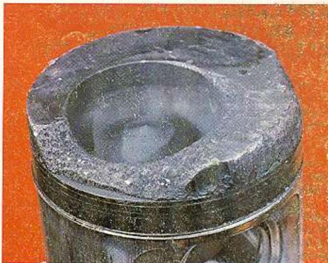
Ilustración 31 — Pistón con erosión en la banda superior.
