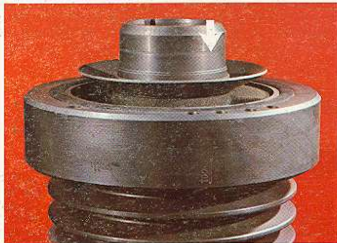
Ilustración 50 — La flecha muestra el punto en que el sello ha desgastado una ranura. Además, el amortiguador tiene deflector.
