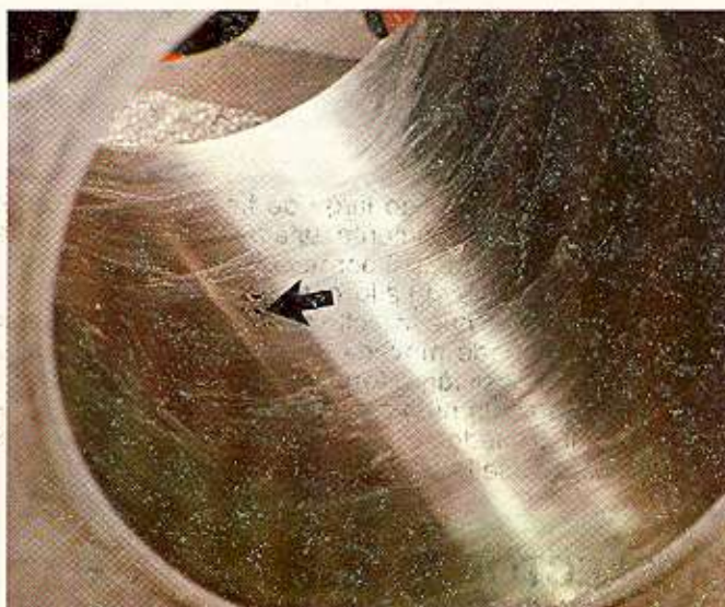
Ilustración 52 — La flecha muestra la ubicación de perforación en la pared del cilindro.
