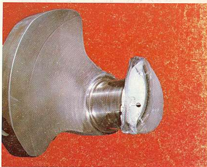
Ilustración 49 — Falla en un brazo del cigüeñal.
