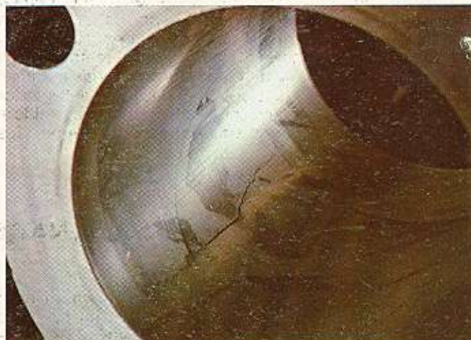
Ilustración 51 — Grieta en el cilindro.
