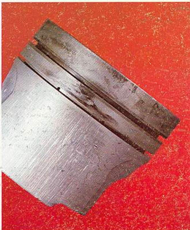
Ilustración 28 — Pistón dañado con rayas verticales en el cuerpo.
