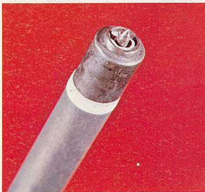
Ilustración 54 — Falla de la punta de la boquilla producida por material defectuoso.
