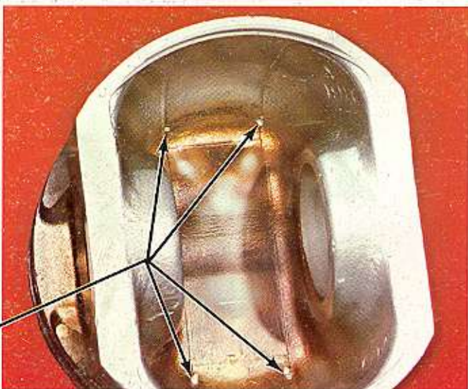
Ilustración 34 — Descoloración del lado de abajo del pistón.
