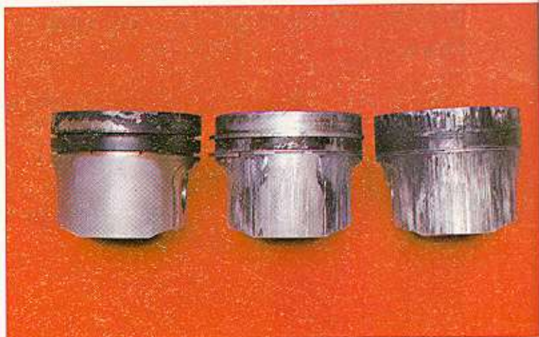
Ilustración 29 — Pistones dañados por sobrecalentamiento del motor.
