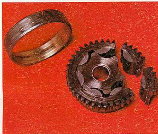
Ilustración 64 — Falla de cojinete de bomba del aceite.
