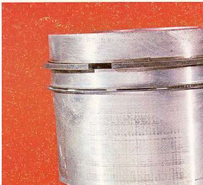
Ilustración 27 — Desgaste típico en el cuerpo del pistón.
