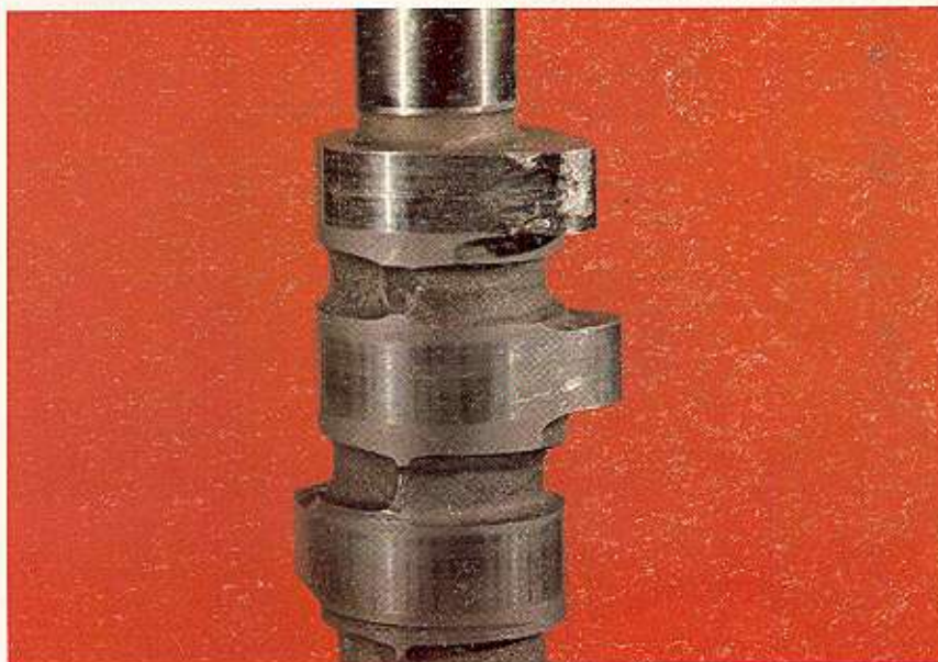
Ilustración 60 — Leva de eje de levas de las bombas de inyección del combustible dañada debido a atascamiento del levantador.
