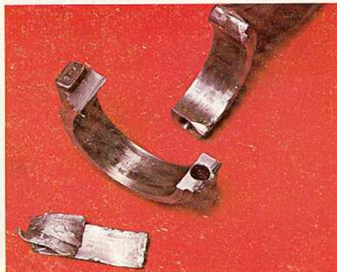
Ilustración 43 — Biela quebrada cerca de la cabeza del perno.
