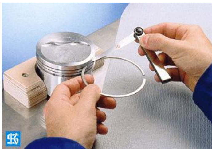
Verificación de las ranuras del segmento con galgas.
