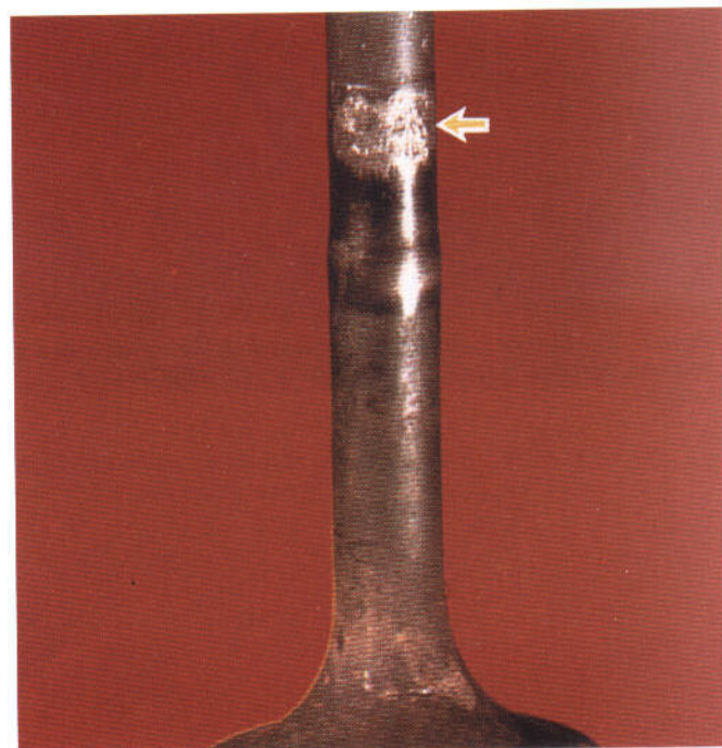
Rozamiento o atascamiento del vástago de válvula.
