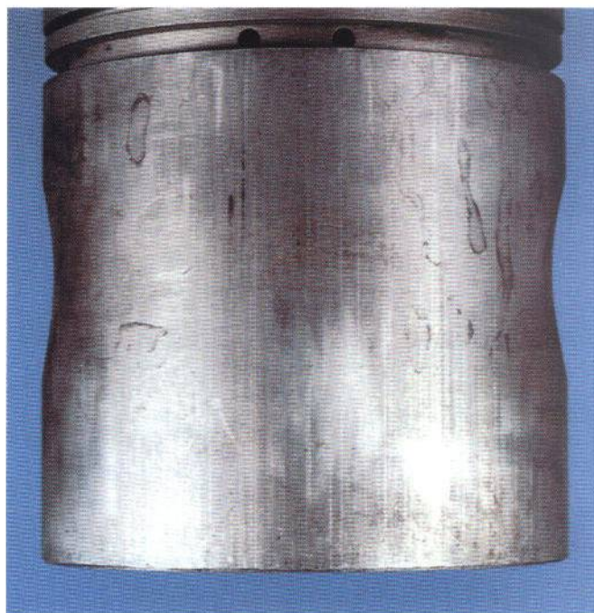
Faldón de pistón dañado por desgaste abrasivo.
