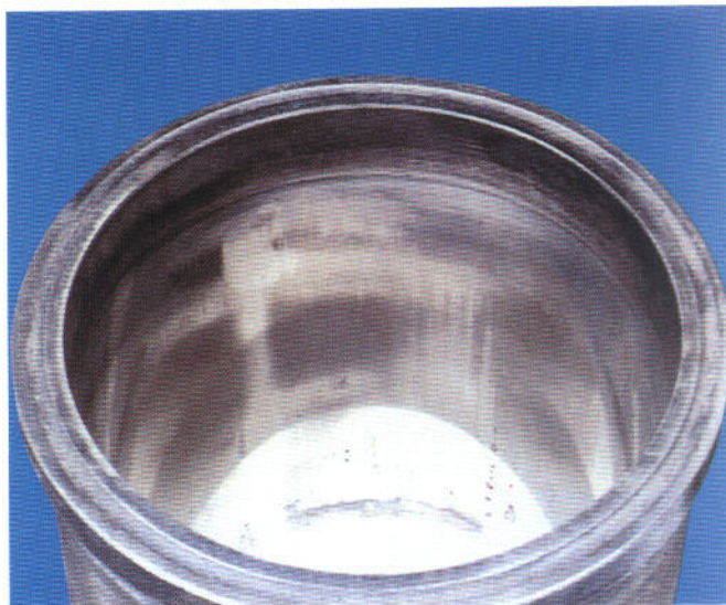
Áreas brillantes en el interior de la camisa causadas por exceso de depósitos en los resaltos del pistón.
