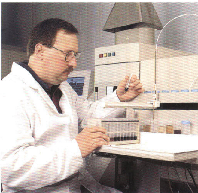
Análisis de una muestra de aceite utilizando un espectrofotómetro de plasma con acoplamiento inductivo.
