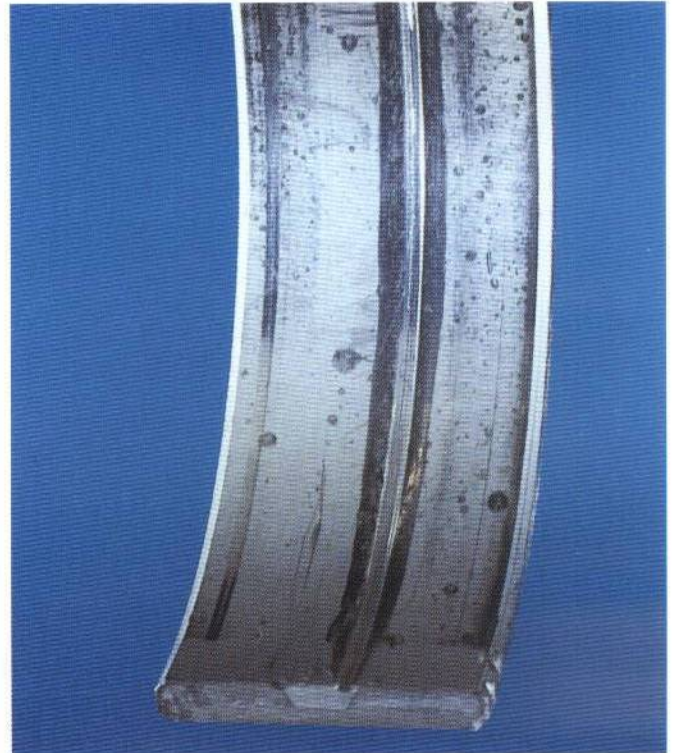
Superficie de cojinete arañada. Note las partículas de basura incrustadas.
