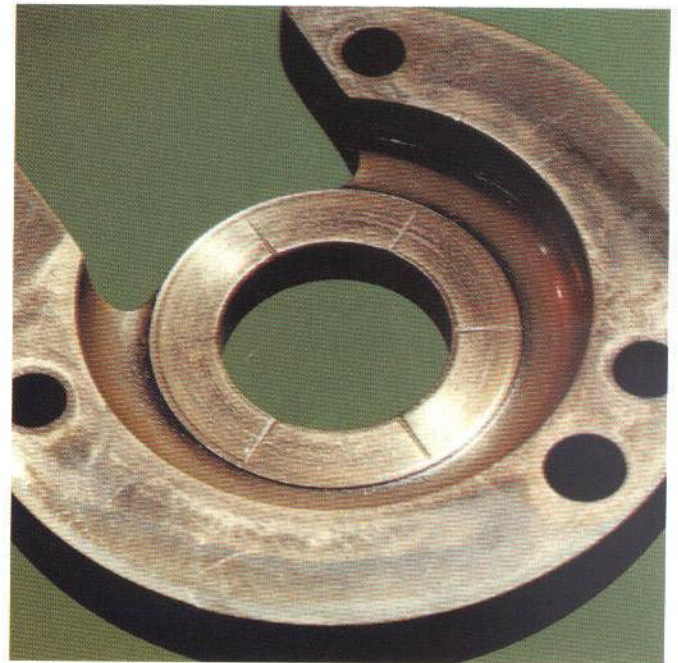
Schwitzer. Superficie pulida de cojinete de empuje causada por partículas abrasivas finas en el aceite.
