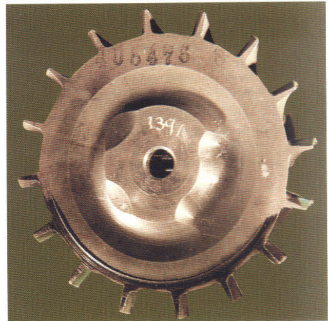
Indicios de rozamiento en la parte delantera y en la parte trasera del rueda compresora. Este es el resultado del movimiento del eje causado por el desequilibrio o el doblamiento del eje durante el armado.
