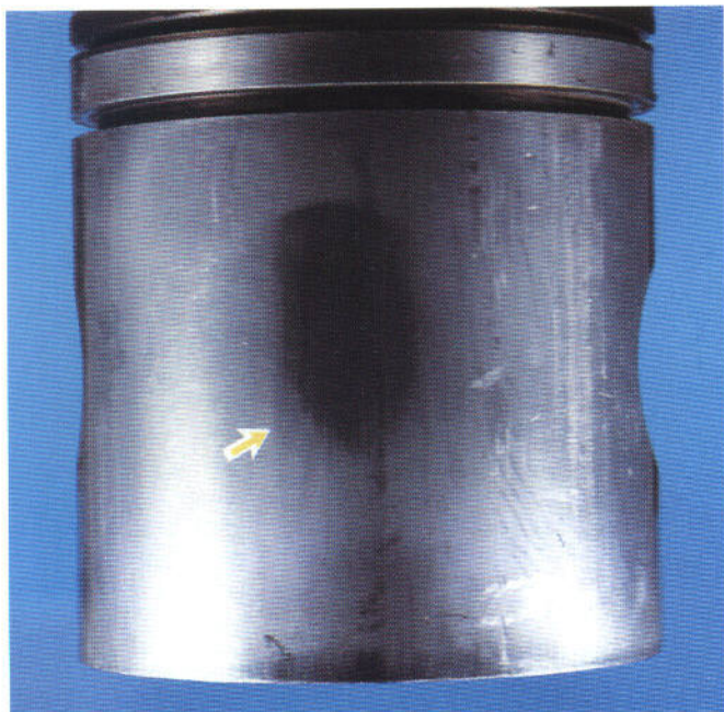
Desgaste causado por falta de lubricación durante un corto periodo de tiempo.
