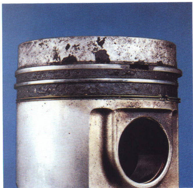
El exceso de depósitos en el primero y segundo resaltos indican que el aceite ya no puede mantener limpio el pistón. El deterioro y la degradación extremos del aceite pueden ser debidos a intervalos prolongados entre cambios de aceite o a la selección de un aceite con la clasificación de rendimiento incorrecta.
