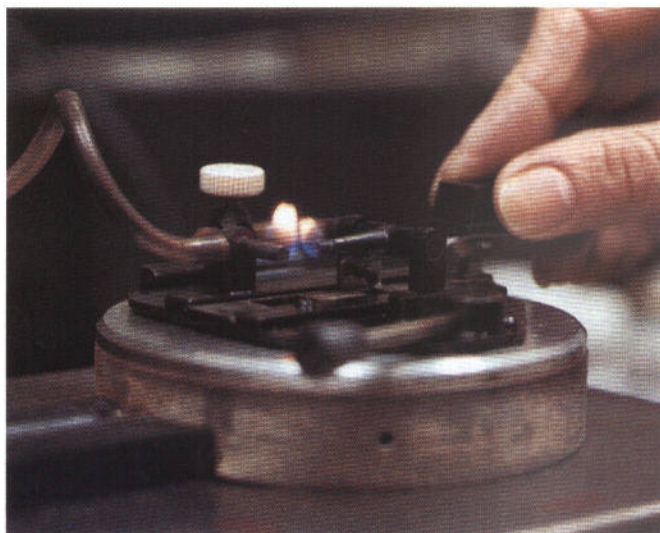
La prueba de destello (Setaflash) verifica y mide la presencia de combustible en el aceite.
