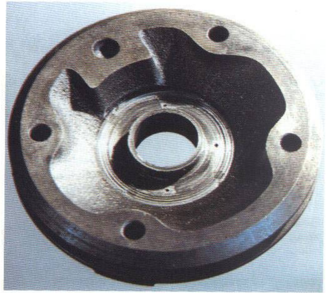
AiResearch. Ranuras de desgaste en las superficies de las arandelas de tope.
