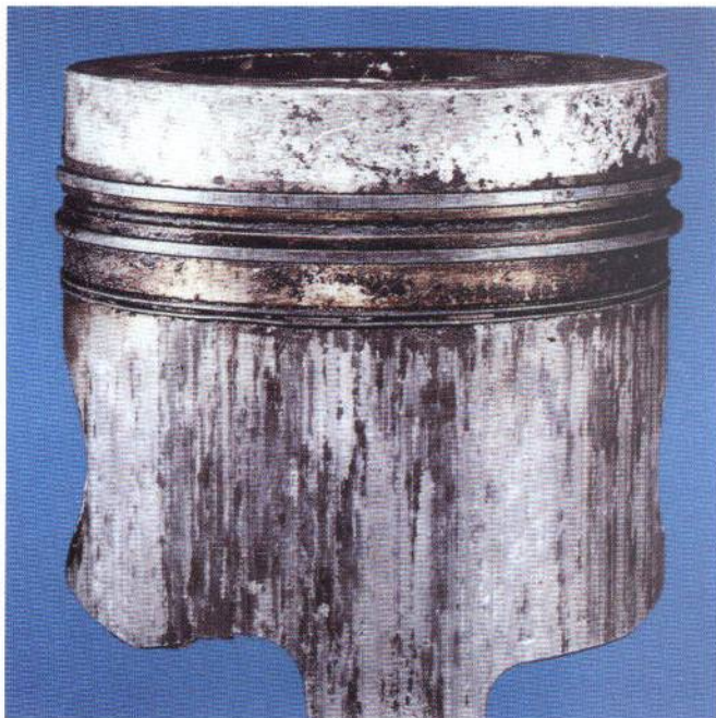
Las marcas de agarrotamiento de arriba hacia abajo pueden indicar una avería del sistema de enfriamiento o del sistema de lubricación.
