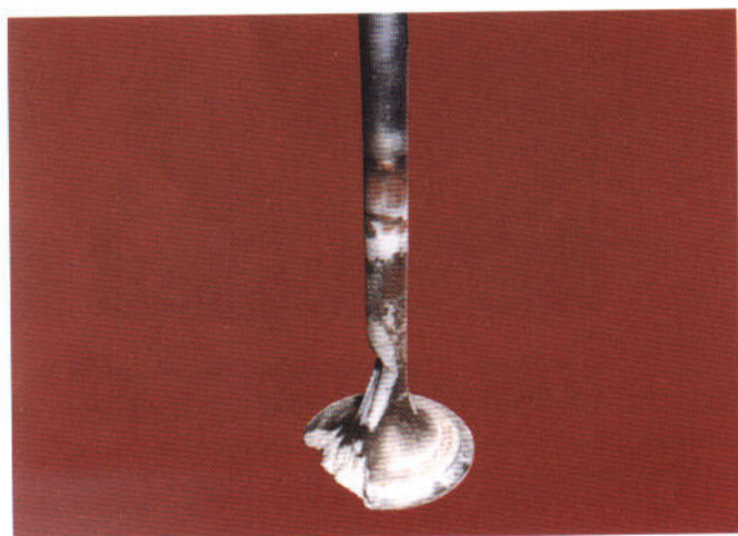
Derretido de la válvula causado por la formación de excesivos depósitos.
