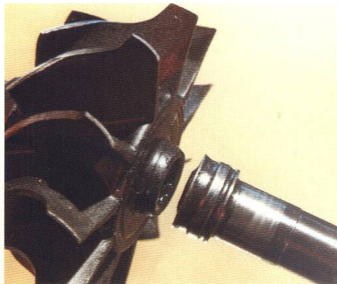
Se rompió el eje al hacer contacto con la maza de la turbina debido a la avería del cojinete de empuje debilitado.
