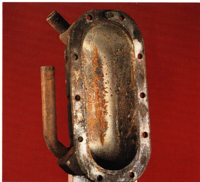
Enfriador de aceite averiado, con depósitos residuales producidos por concentración excesiva de anticongelante en la mezcla de refrigerante y por obstrucciones del flujo de refrigerante en los tubos de enfriamiento.
