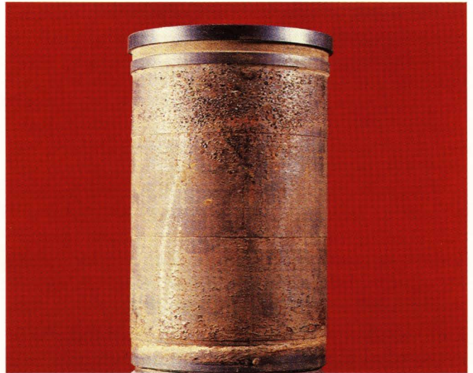
Depósitos de herrumbre en la superficie exterior de la pared del cilindro.
