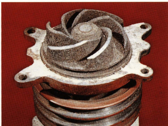
Rodete de una bomba de agua con depósitos de herrumbre resultantes de la falta de aditivo refrigerante suplementario.
