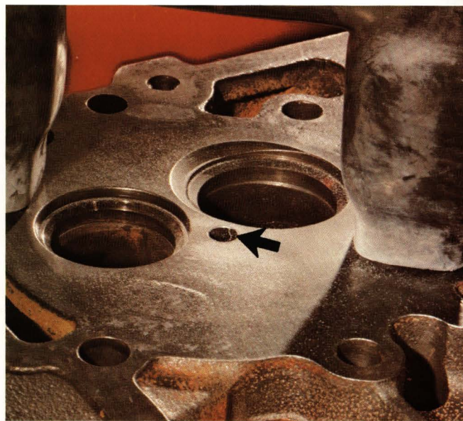
El recalentamiento relacionado con el refrigerante produjo esta grieta en la culata cerca del agujero para el inyector.
