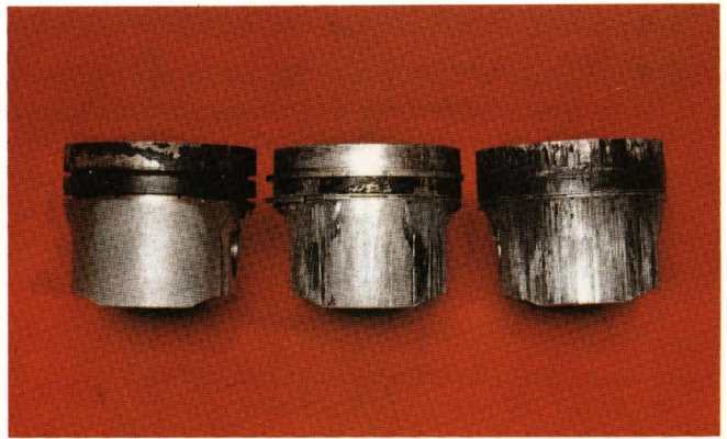
Este motor de inyección directa tiene pistones dañados por causa del enfriamiento inadecuado de las camisas de cilindro. Como muestra el pistón central, el atascamiento frecuentemente comienza alrededor del faldón mientras el resalto superior queda sin daños. El faldón del pistón a la derecha muestra aún más desgaste.
