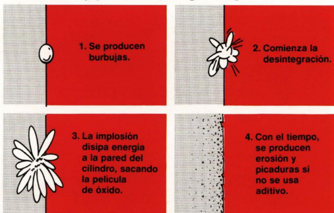
Efectos acumulativos de la cavitación y de las picaduras en la pared del cilindro.
