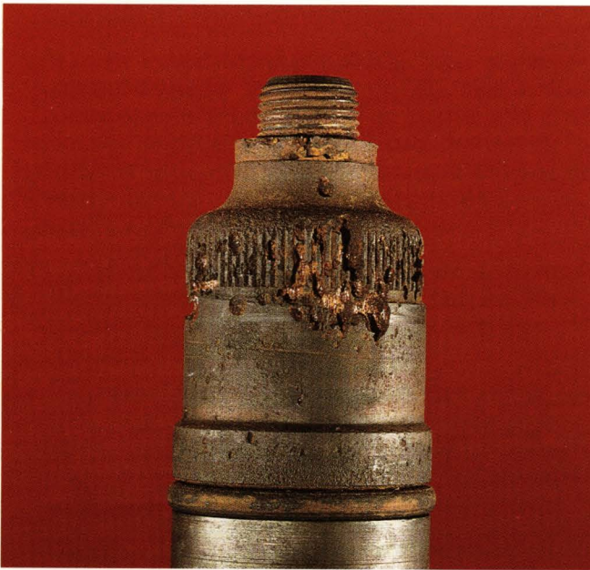
Corrosión dañina en una cámara de precombustión, causada por la falta de aditivo refrigerante suplementario en el sistema de enfriamiento.
