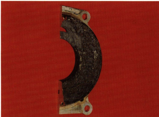
Corrosión/erosión del aluminio. Se muestra el adaptador de la bomba de agua del 3406 (4W4774).
