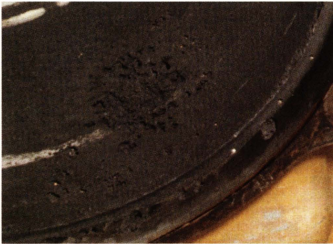
Sistema de enfriamiento corroído a causa de protección inadecuada durante pruebas en el laboratorio.
