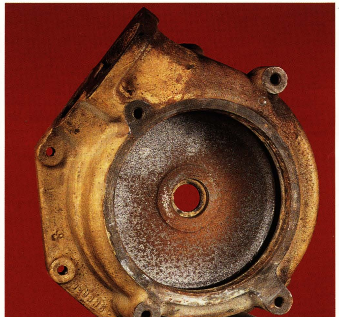
Herrumbre dentro de la bomba de agua.
