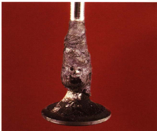
Acumulación excesiva de carbón en una válvula de admisión. La acumulación de carbón puede ser resultado de la operación del motor a temperaturas frías.
