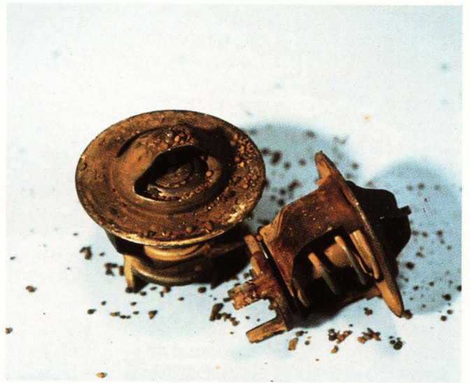
Se produjeron depósitos de herrumbre y escamilla porque no se agregó aditivo refrigerante suplementario. Resultado: la falla de los reguladores de temperatura.
