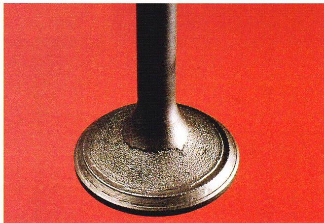
Figura 14: La corrosión de las válvulas por el vanadio
