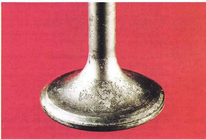
Figura 13: Daños por causa del azufre del combustible
