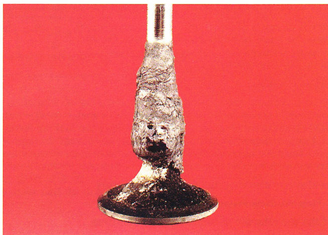
Figura 15: Acumulación excesiva de carbón
