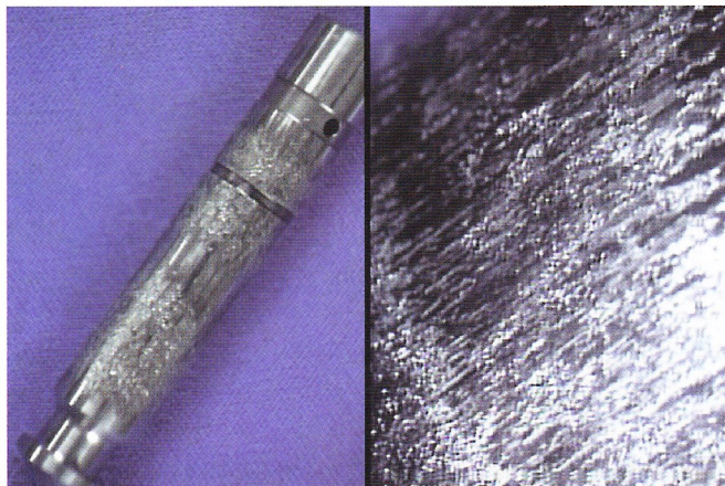
Figura 9: Ejemplo de restregado de émbolo debido a desechos en el combustible
