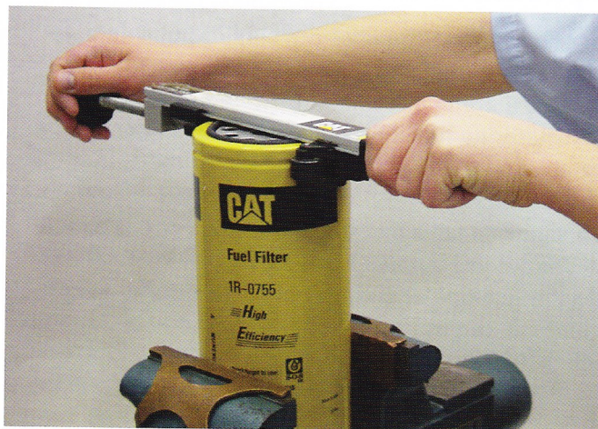
Figura 35: Corte los filtros usados para ver los contaminantes. Utilice un Cortador de filtros 6V7905 para cortar la caja del filtro.
