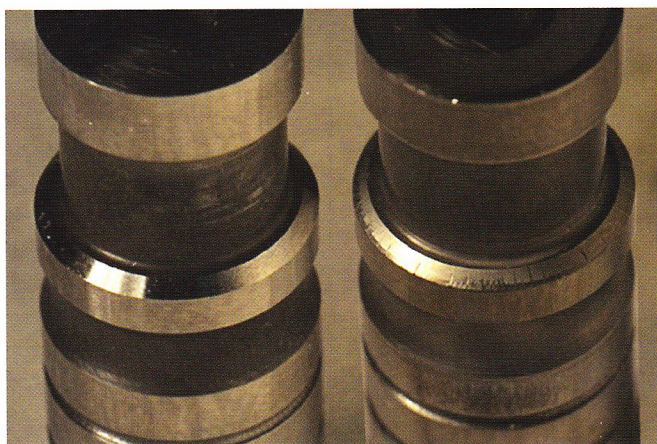
Figura 33: Se necesita combustible limpio y de alta calidad para lubricar las piezas móviles de los inyectores unitarios modernos. La válvula de contrapunta del inyector unitario del lado derecho muestra desgaste por causa de contaminantes en el sistema de combustible.
