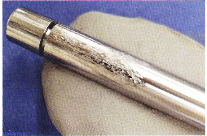
Figura 6: Desgaste del émbolo por restregado debido a que el agua en el combustible destruye la película de lubricación
