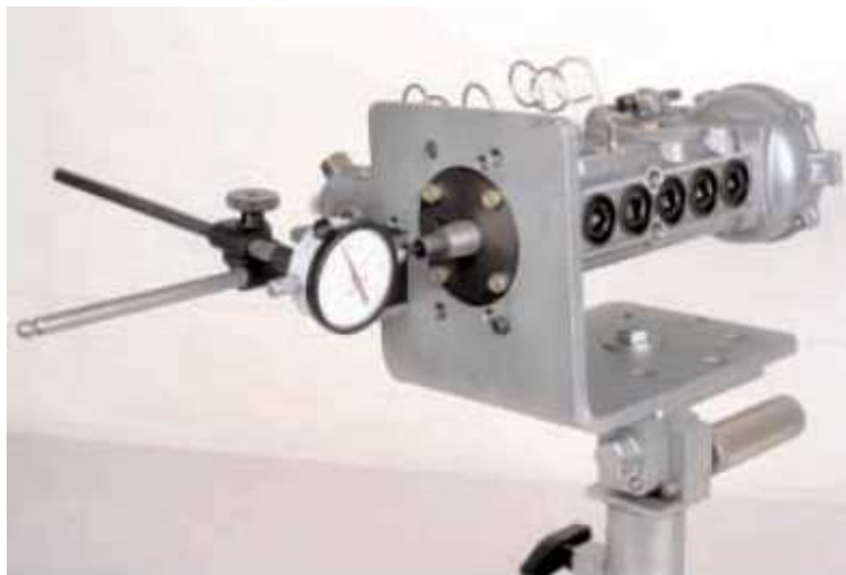
Fig. 7.2.15 Revisión del juego axial del árbol de levas
