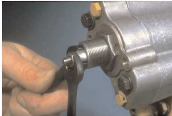
Fig. 3.2.59 Aflojamiento de la tuerca de seguridad de extensión de la válvula
