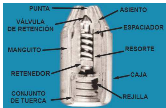
Fig. 2.3.1 Componentes del inyector de cápsula de PC
