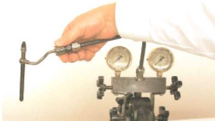
Fig. 2.4.22 Inyector instalado en el equipo de prueba.
