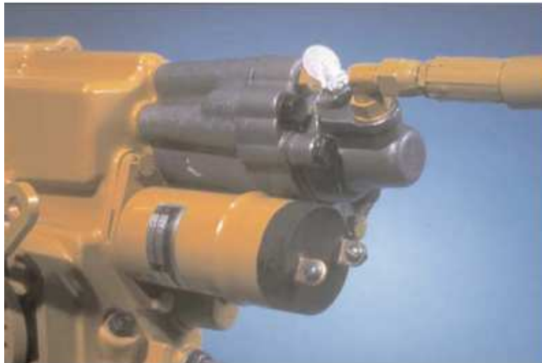
Fig. 3.2.44 Revisión del regulador y el control de la relación de aire-combustible
