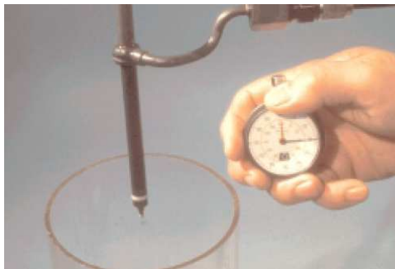
Fig. 2.4.29 Prueba de fuga por la punta.
