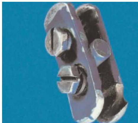
Fig. 2.3.16 Daño por vibración en la abrazadera.
