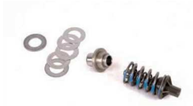
Fig. 4.2.14 Precarga del resorte del regulador
