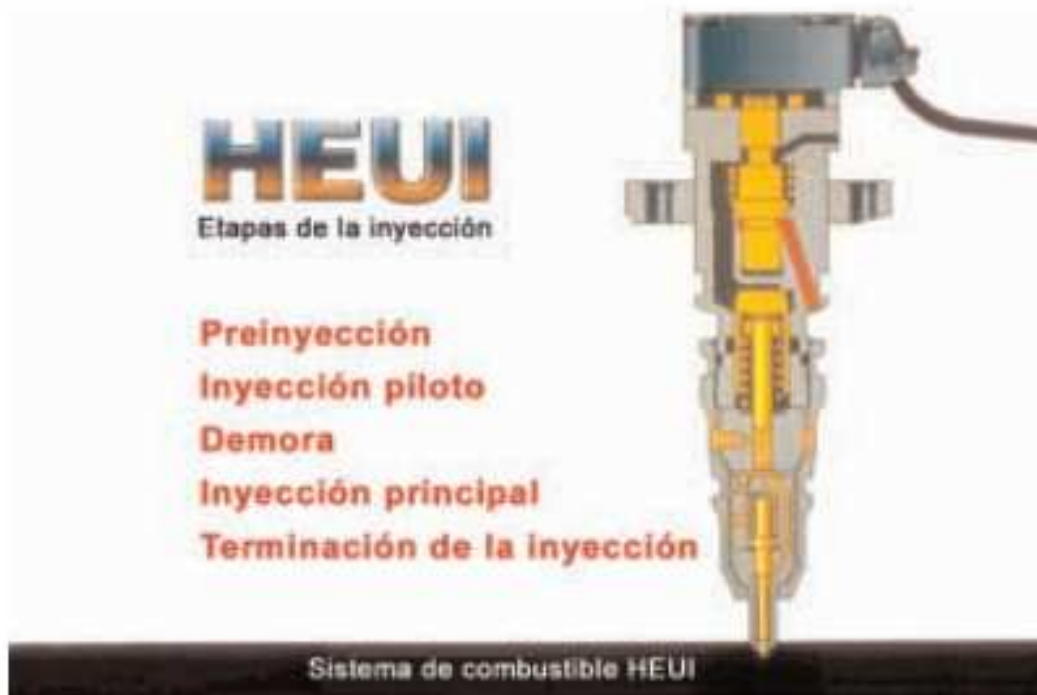
Fig. 5.1.42 Etapas de inyección del HEUI HI300
