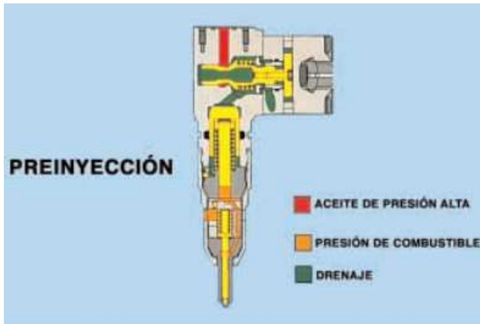
Fig. 5.1.25 Inyector HEUI (Preinyección)
