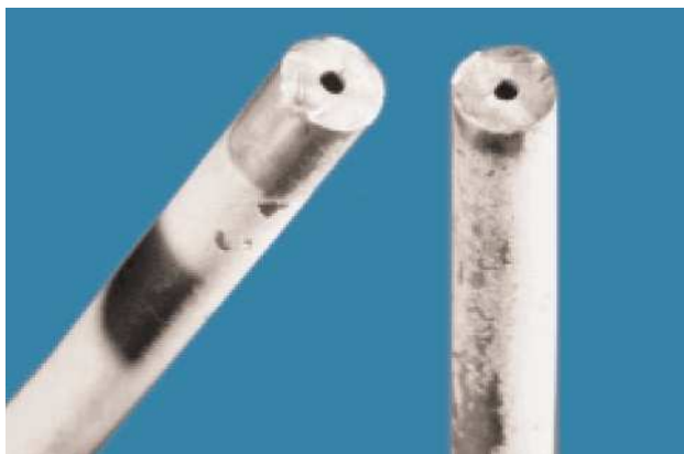
Fig. 2.3.13 Tensión en la tubería de combustible
