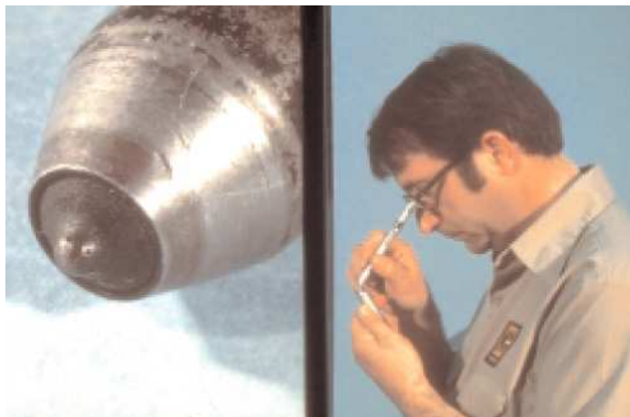
Fig. 2.4.40 Orificio de inyector y microscopio 6V2196.
