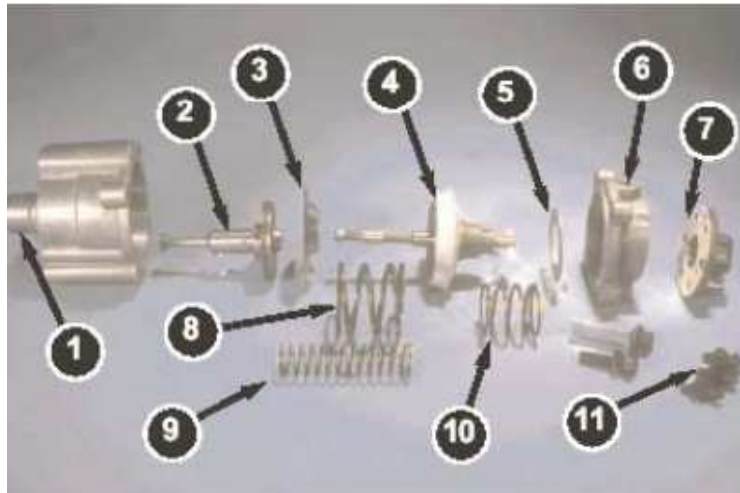
Fig. 3.2.6 Control de la relación de aire-combustible (modelo más reciente)
