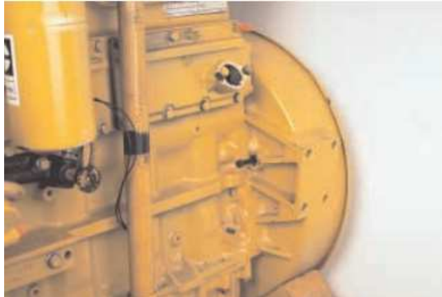
Fig. 4.5.4 Gire el cigüeñal en sentido de giro normal
