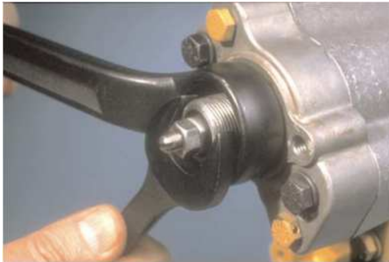
Fig. 3.2.57 Giro del tope de precarga
