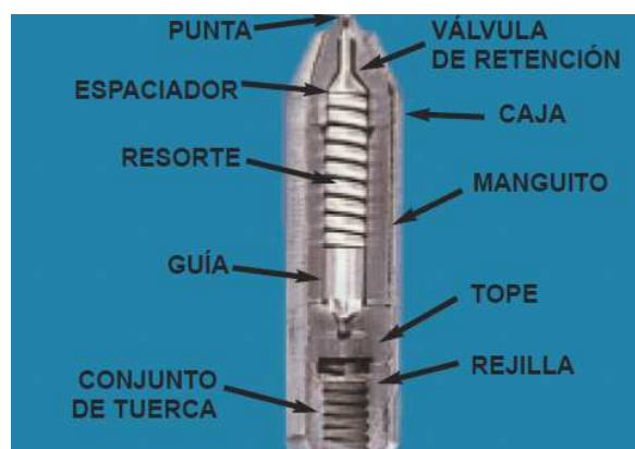
Fig. 2.3.2 Componentes del inyector de cápsula de inyección directa (DI)
