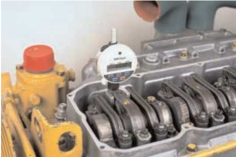
Fig. 4.5.7 El indicador muestra la sincronización actual
