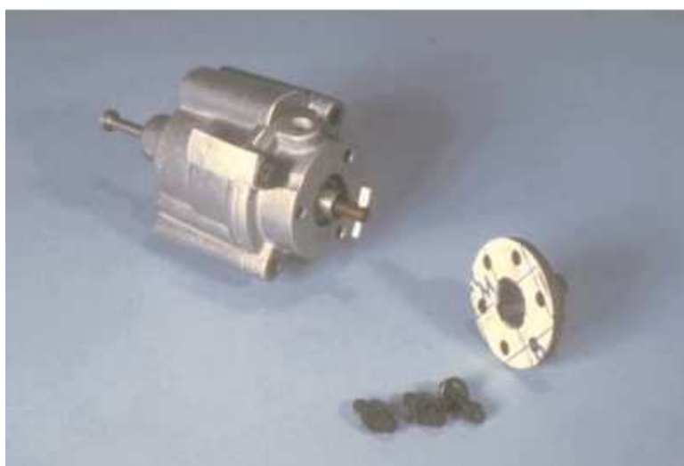
Fig. 3.2.9 La tapa gira para hacer el ajuste
