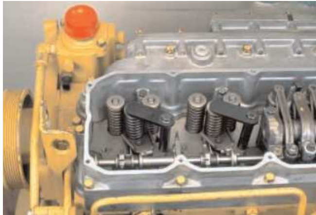
Fig. 4.3.5 Compresores de resorte instalados
