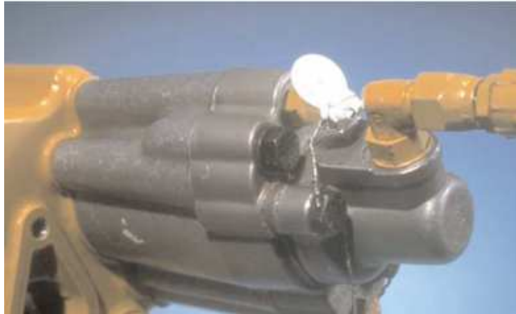
Fig. 3.2.63 Control con sello y alambre de seguridad instalado
