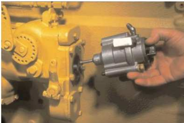
Fig. 3.2.16 Remoción del control del regulador
