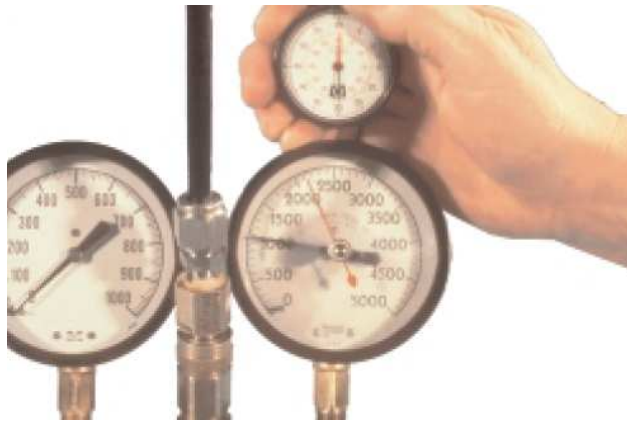
Fig. 2.4.44 Prueba de pérdida de presión.
