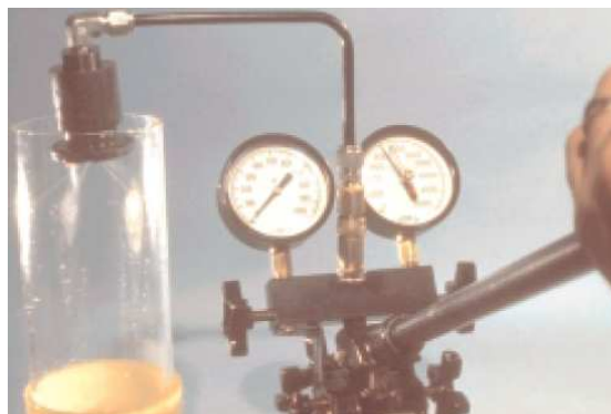
Fig. 2.4.47 Prueba de la VOP.
