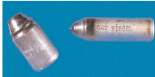
Fig. 2.3.3 Marcas de identificación de los inyectores de cápsula DI y PC
