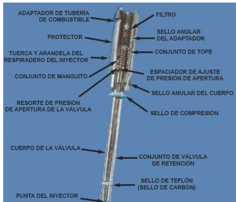
Fig. 2.3.8 Inyector DI (Serie 7000)
