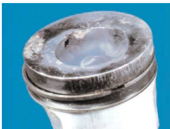
Fig. 2.3.19 Daño del pistón, por causa de una sincronización de inyección incorrecta.
