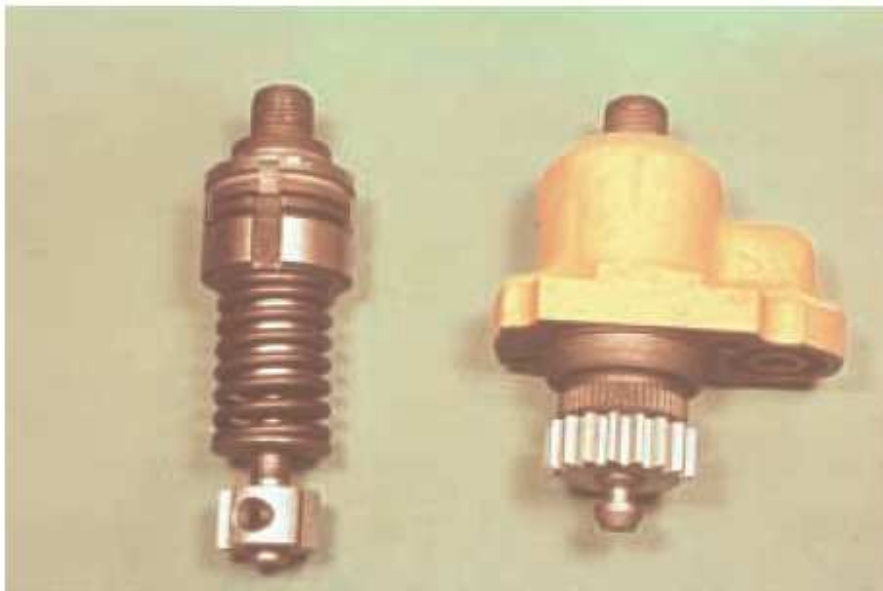
Fig. 3.1.51 Bombas de inyección.
