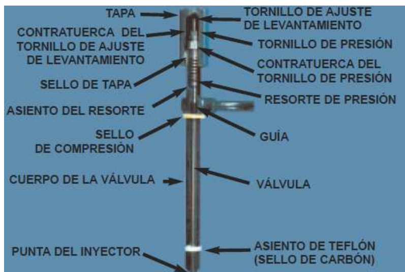
Fig. 2.3.7 Inyector DI (sin cápsula)
