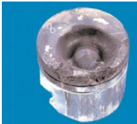
Fig. 2.3.17 Pistón dañado por una falla del inyector de combustible
