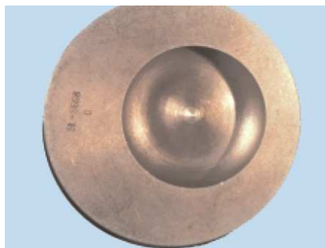
Fig. 2.4.33 Cráter de combustión en la corona del pistón.
