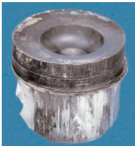
Fig. 2.3.18 Pistón dañado por causa diferente a una falla del inyector de combustible
