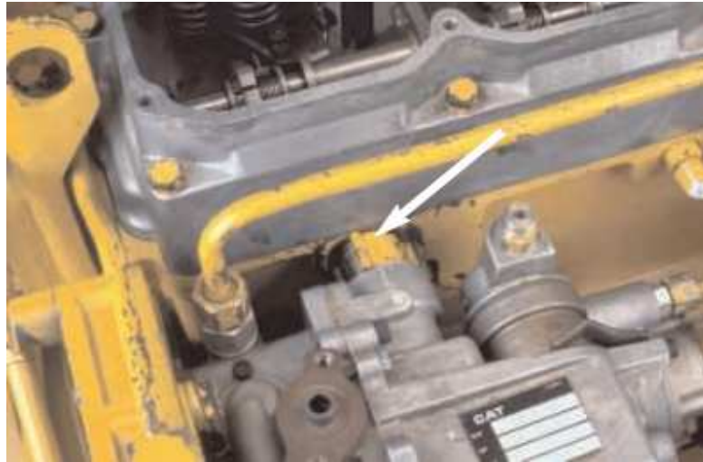
Fig. 4.4.3 Remoción del manguito del regulador
