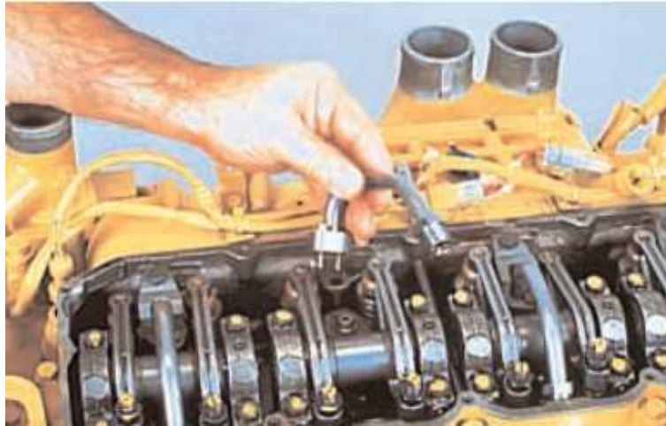
Fig. 5.1.22 Instalación del tubo de conexión puente
