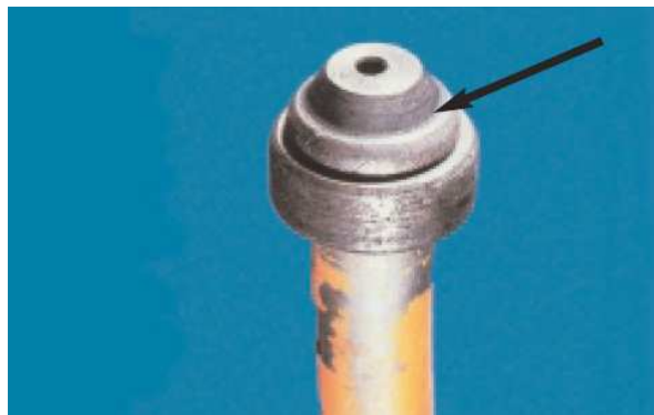
Fig. 2.3.9 Daño de la tubería de combustible
