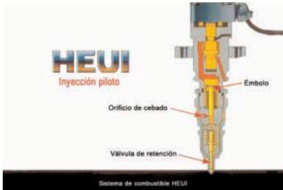
Fig. 5.1.44 Inyector HEUI HI300 (CEBADO)
