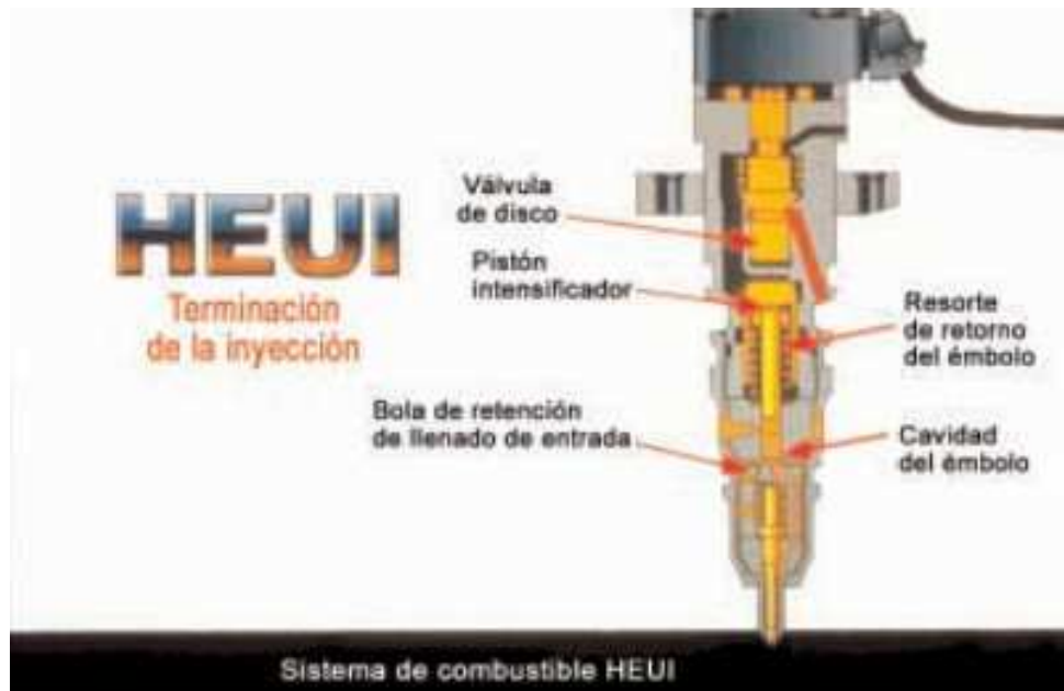
Fig. 5.1.47 Inyector HEUI HI300 (terminación de la inyección)
