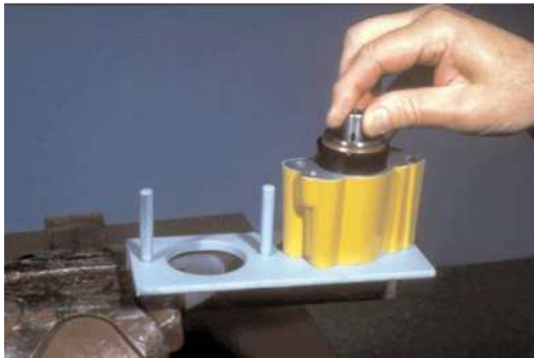
Fig. 3.2.41 Instalación del conjunto de pistón
