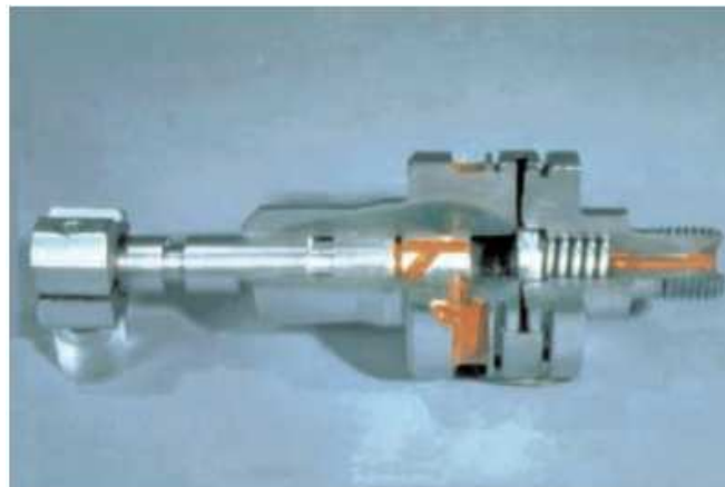
Fig. 3.4.13 Bomba de inyección (entrega de combustible)
