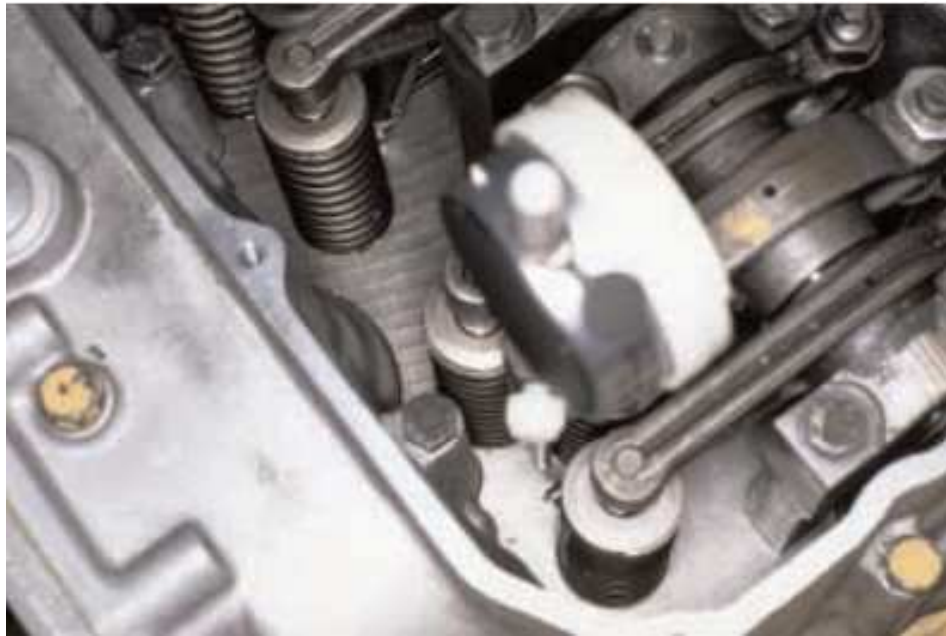
Fig. 4.5.6 Indicador digital de la parte superior del botador del inyector
