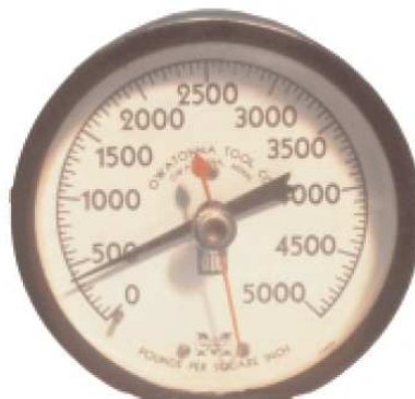
Fig. 2.4.13 Manómetro en mal estado.
