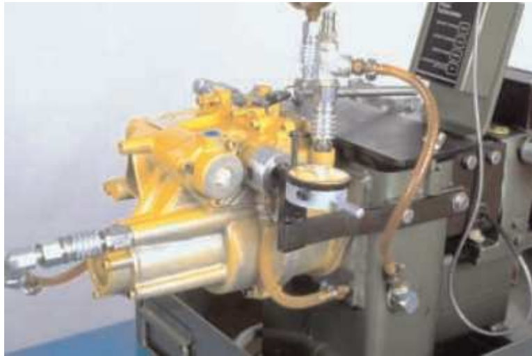
Fig. 4.2.17 Mediciones del regulador
