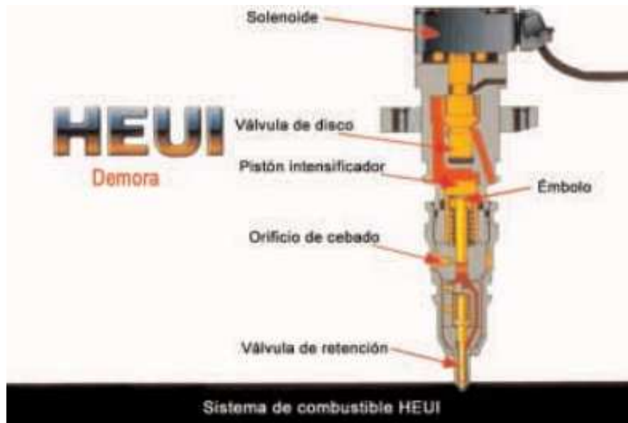
Fig. 5.1.45 Inyector HEUI HI300 (Demora)
