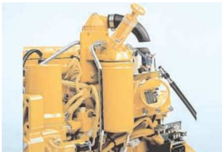
Fig. 5.1.39 Ubicación de la bomba HEUI (3126B)
