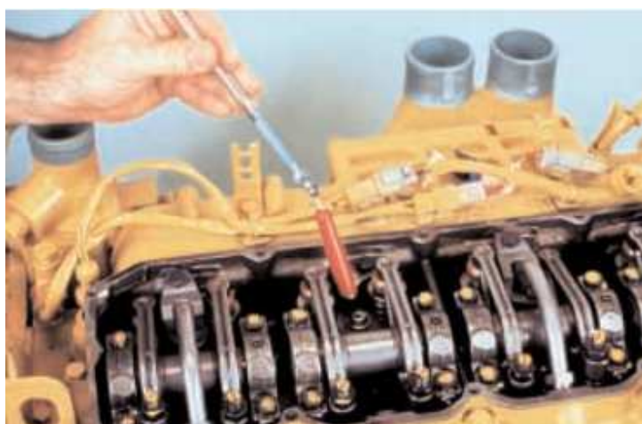
Fig. 5.1.14 Remoción del tubo de conexión puente
