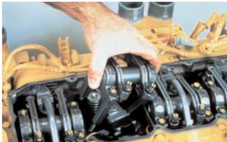
Fig. 5.1.16 Remoción del conjunto del balancín
