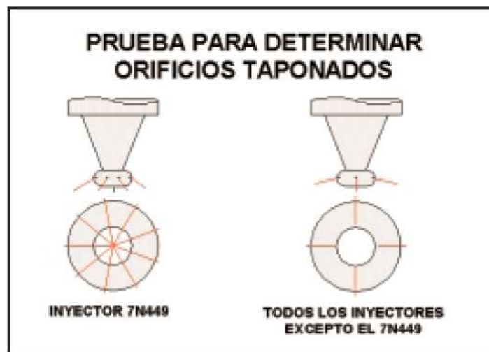
Fig. 2.4.31 Patrón de la prueba de orificio taponado.
