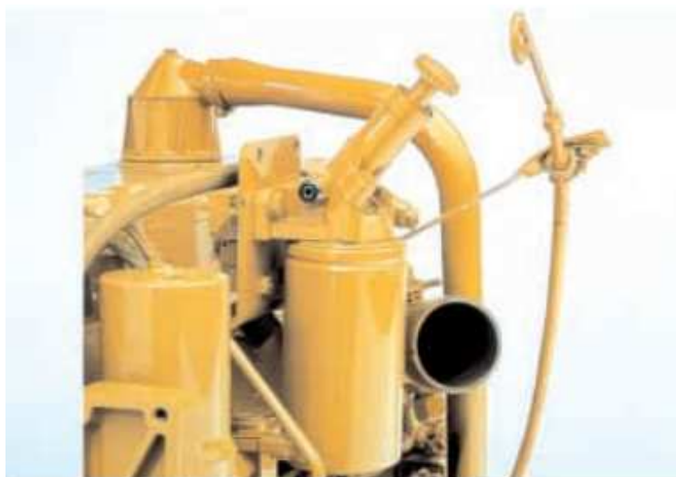
Fig. 5.1.38 Bomba de cebado y filtro de combustible (3126B)
