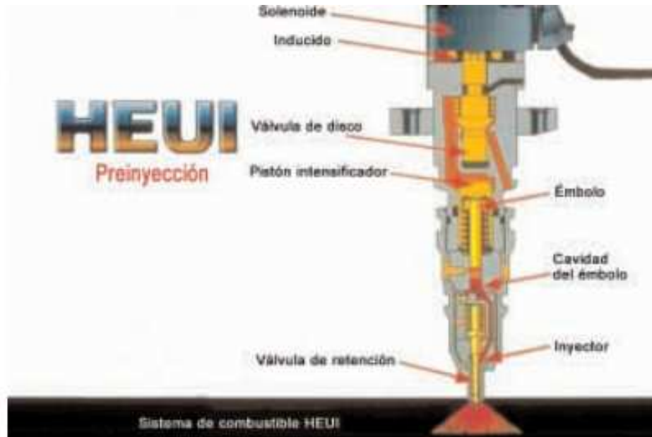
Fig. 5.1.43 Inyector HEUI HI300 (Preinyección)
