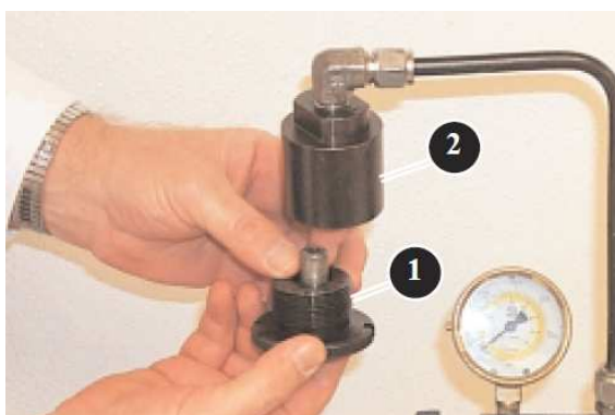
Fig. 2.4.41 Instalación del inyector en el equipo de prueba.
