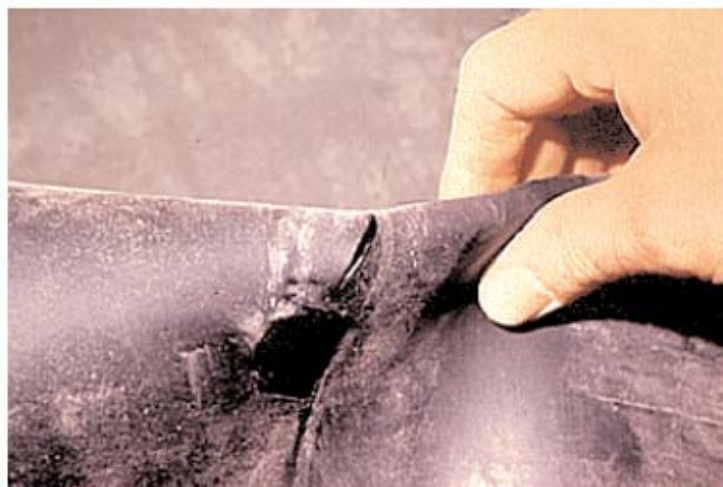
Fig. 3.1.7 Falla de la cámara del acumulador
