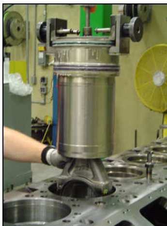
Fig. 1.36 Remoción del cylinder pack
