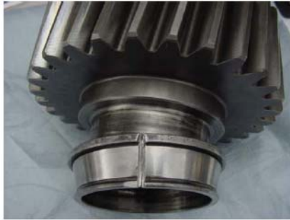
Fig. 1.17 Corte para remoción de pistas
