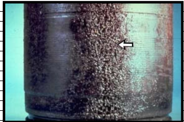
Fig. 1.32 Desgaste erosión por cavitación
