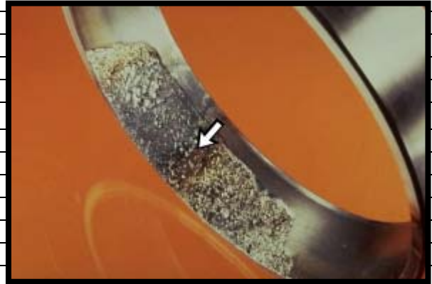
Fig. 1.33 Desgaste Fatiga por esfuerzo de contacto
