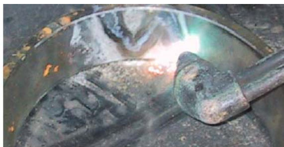
Fig. 1.19 Uso incorrecto del soplete
