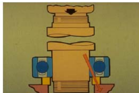
Fig. 1.13 Instalación y remoción de rodamientos
