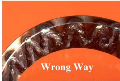
Fig. 1.20 Uso incorrecto del soplete
