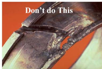
Fig. 1.18 Daños por uso de soplete
