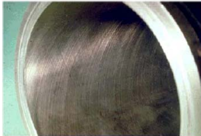
Fig. 6.2 Achurado de superficie interna de camisa
